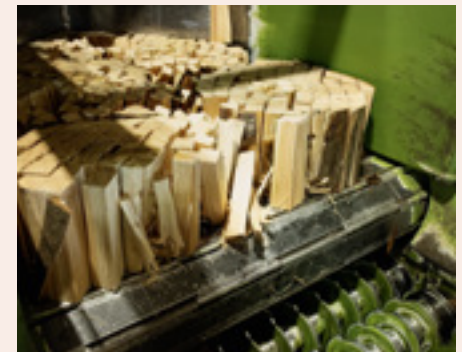
Danach werden die Stammstücke mit einer hydraulischen Presse gespalten.
