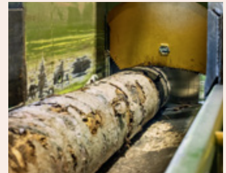
Die Stämme werden in die richtige, den späteren Scheiten entsprechende Länge zersägt.
