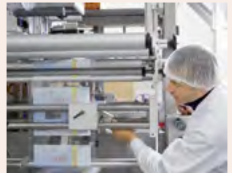
Vor dem Abfüllen prüft Anlageführer Visar Dedaj, ob die Folien für den Volg Familienpreis-Reibkäse korrekt eingespannt sind.
