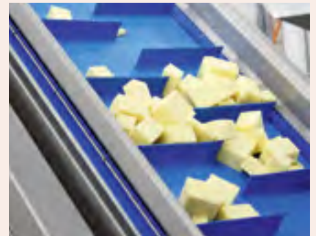
Die Käseläibe werden entrinde, in verschiedenen Arbeitsvorgängen immer mehr zerkleinert und zuletzt fein oder etwas gröber gerieben.
