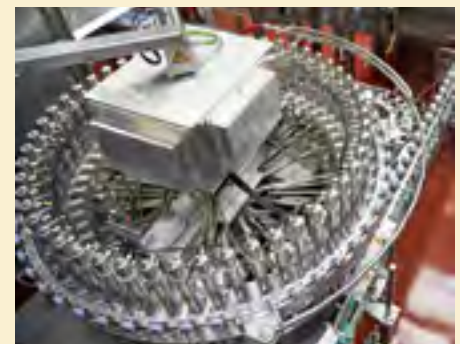
Ausgespült und unter Vakuum werden pro Stunde 25 000 Dosen Volg Bier abgefüllt.
