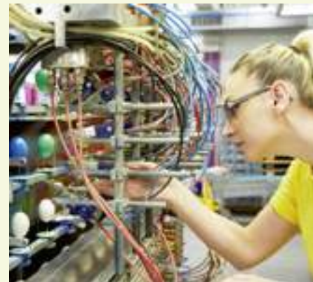
Die Linienführerin Valdete Alifi überprüft die punktgenaue DüsenEinstellung der Spritzanlage zum Färben der Eier.
