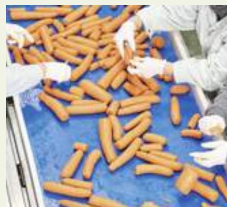
Bei 2,5 Tonnen Rüebli pro Stunde werden Grünstellen entfernt, bevor sie nach dem Aussortieren von unschön Verfärbten geschnitten, blanchiert und tiefgekühlt werden.
