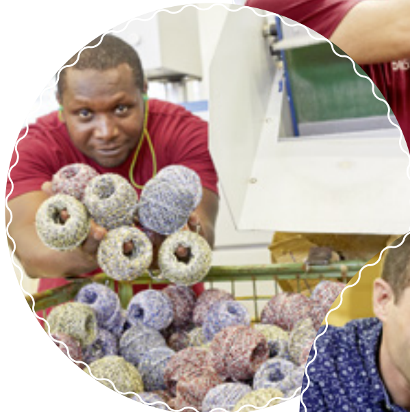
Amadou Gaye schaut, dass die Schnüre von der Spindelbank zu formschönen Knäueln aufgewickelt werden.
