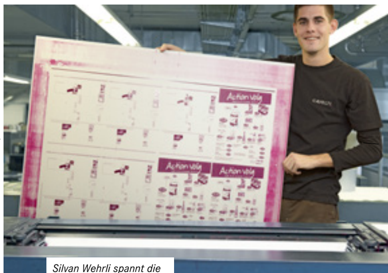
Silvan Wehrli spannt die Druckplatten in die Maschine ein – für jede der vier Grundfarben eine Platte.
