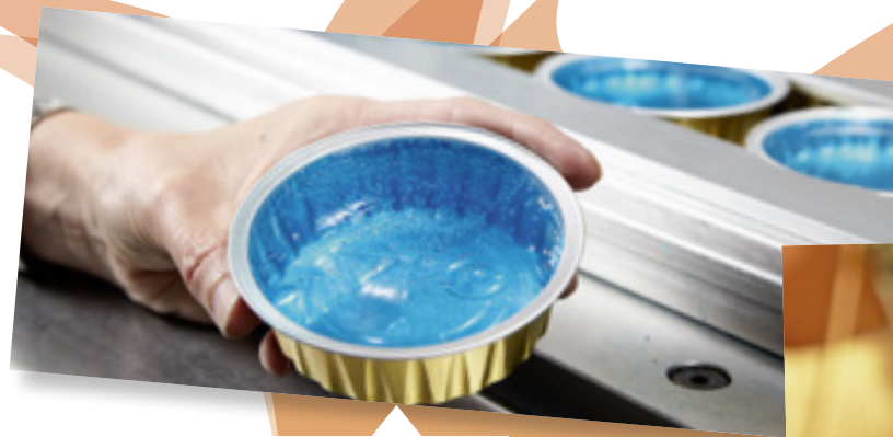
Im schönsten Ozeanblau – am Fliessband werden die Aluminiumschalen mit der Brennpaste aufgefüllt.
