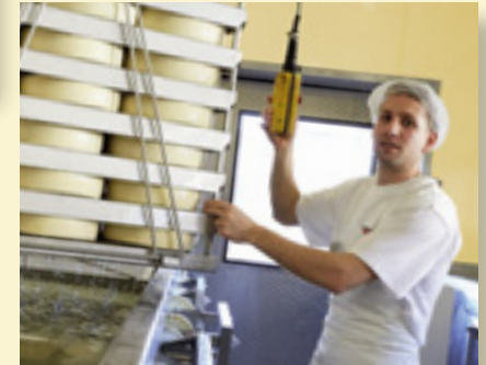
Die Käsekörner, «Käsebruch» genannt, werden in Formgefässe abgefüllt und zum Abtrennen von Molke und Feuchtigkeit maschinell gepresst, bevor Idriz Djemaljija, der gelernte Käser, die Formen auf Transportbleche stapelt. In dieser Phase wird aus zehn Litern Milch ein Kilo Käse.
