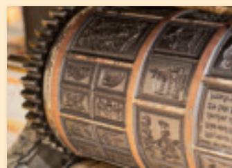
1. Die Motive werden mit dem Form-Zylinder auf den nach alter Rezeptur hergestellten rohen Teig geprägt.
