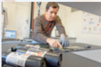
4. Die Säcke werden aufgerollt und mit Banderolen umwickelt. Im Labor werden sie regelmässig auf ihre Reissfähigkeit geprüft.
