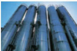
1. Die Grundlage der Abfallsäcke ist Polyethylen. Dessen Granulat wird in Silos gelagert.
