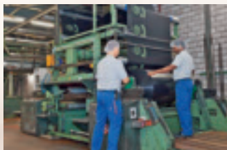
3. Die abgekühlte Folie wird bedruckt und auf Rollen gewickelt. Die Konfektionierungsmaschine verschweisst sie zu Säcken.
