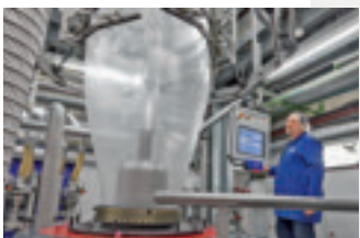
2. Im Extruder wird das Granulat erhitzt, bis es flüssig ist, und mit Luftdruck zu einer Endlosfolie 10 Meter in die Höhe geblasen.
