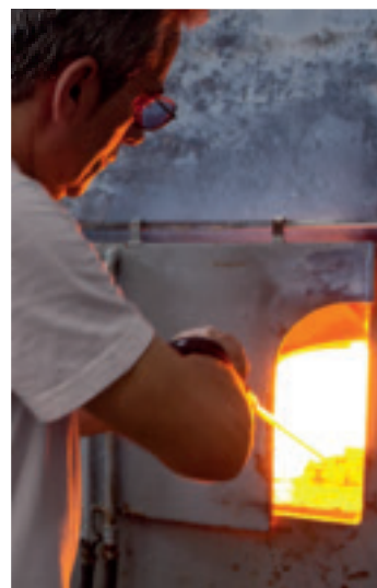
Ein Glasmacher entnimmt das flüssige Glas aus dem Wannenofen, in dem es bis zu 1500 Grad heiss ist.
