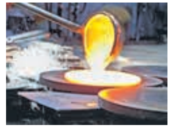
1. Glasmachen ist Teamarbeit. Ein erster Glasmacher schöpft die honigartige Masse aus dem Ofen auf eine flache Eisenplatte.
