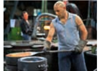
2. Ein zweiter Glasmacher «bügelt» die Masse, er presst sie mit einem Holz-Model flach.
