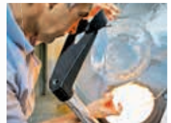
5. Mit einem Polarisationsfilter wird vor dem Verpacken geprüft, ob noch Spannungen im Glas sind.
