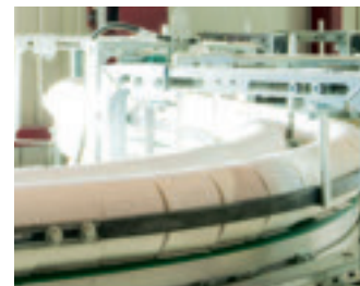
In der Verarbeitungsanlage wird aus Mutterpapier vollautomatisch versandfertiges WC-Papier.
