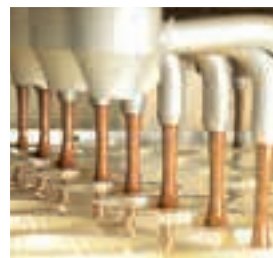
Automatisch wird die Couverture für die Eihüllen eingefüllt.
