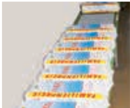
Auf Rollbahnen werden die fertigen Beutel der Palettierung zugeführt.
