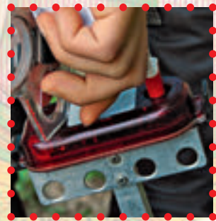
Mit diesem «elektronischen Finger» bestätigt man, dass man den Posten gefunden hat. Dazu wird er in das Kästchen gesteckt. Er speichert auch die Laufzeit.
